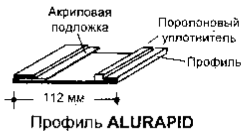
Рис. 14.4. Профили для создания объемных знаков
