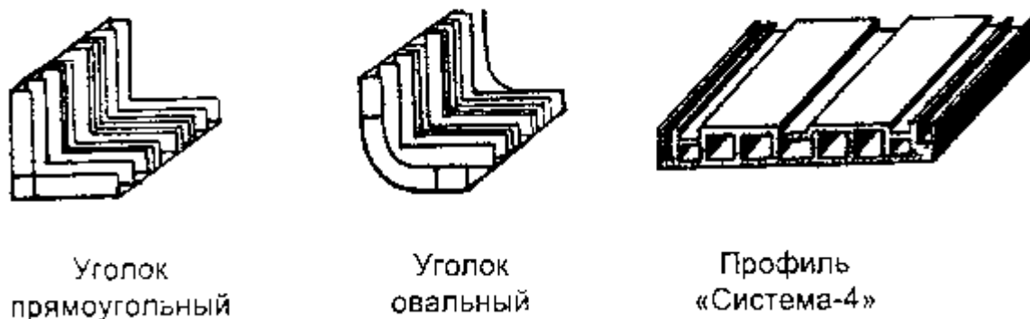
Рис. 14.2.Пластиковые профили для световых коробов
