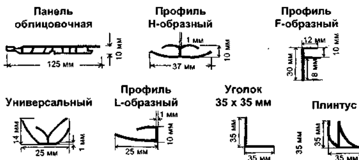
Рис. 6.14 Многоцелевые профили из ПВХ отечественного производства белого цвета. Используются для окантовки различных материалов толщиной 8-10 мм.
