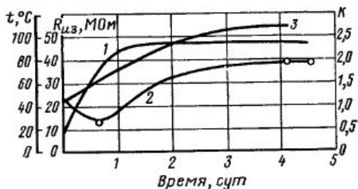
Рис. 15. Изменение параметров изоляции при сушке: 1 – температура, °С; 2 – сопротивление изоляции, МОм; 3 – коэффициент абсорбции [29].
