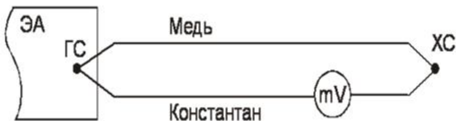
Рис. 9. Схема измерения температуры методом термопары [22].
