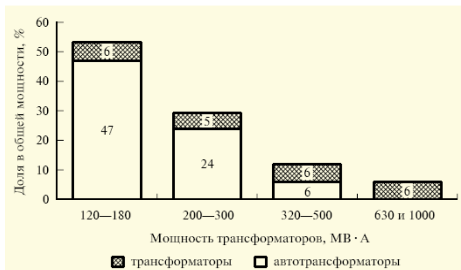
Рис. 17. Распределение мощности трансформаторов и автотрансформаторов [31].
