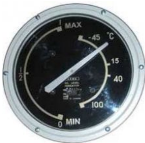
Рис. 21. Внешний вид стрелочного маслоуказателя [36]
