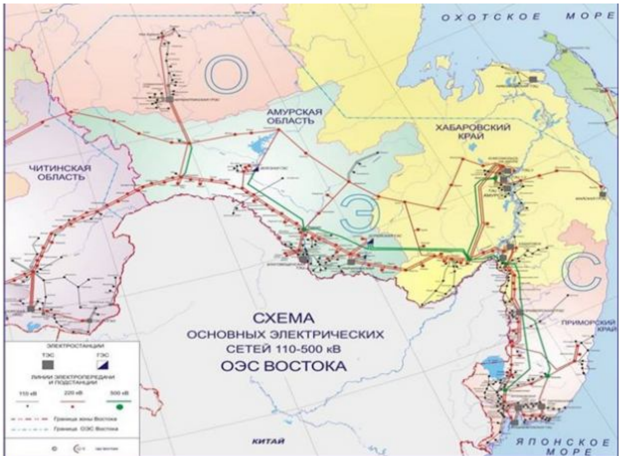
Рис. 2. Схема основных электрических сетей 110-500 кВ ОЭС Востока [7].
