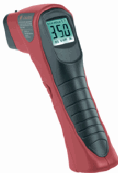
Рис. 11. Инфракрасный термометр ST350. Диапазон измерений: -25^{\circ}\text{C} - +400^{\circ}\text{C} ; Разрешение: 1^{\circ}\text{C} ; Точность измерений температуры \pm(2\%+1^{\circ}\text{C}) [24].
