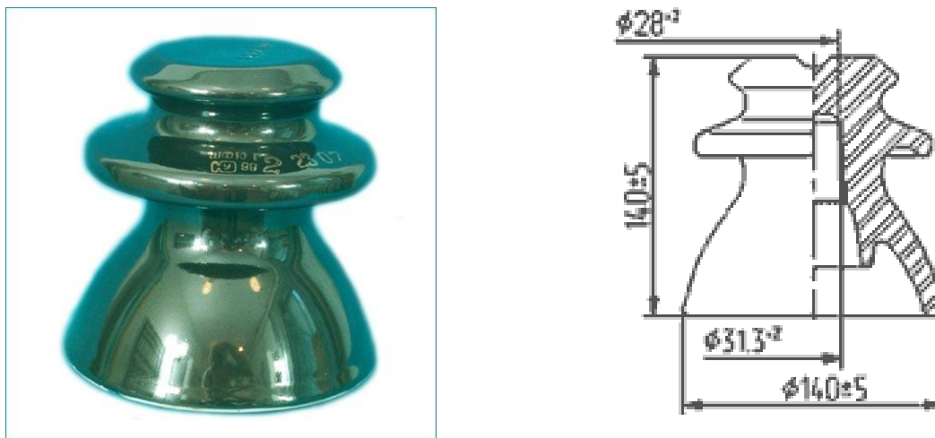
Рис.3. Изолятор линейный штыревой фарфоровый ШФ10Г
