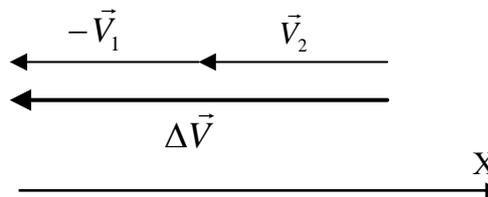
Приращение модуля вектора скорости (длина вектора  $\Delta\vec{V}$  в единицах скорости). Согласно чертежу  $|\Delta\vec{V}| = 2V_1 = 2V$ , (т.к.  $V_1 = V_2 = V$ ).
