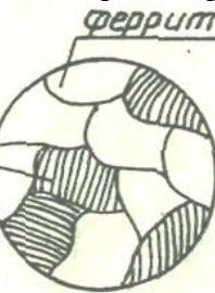
Рис. 3.3. Структура доэвтектоидной стали
