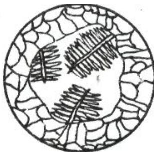
Рис. 1.4. Схема кристаллизации хлористого аммония
