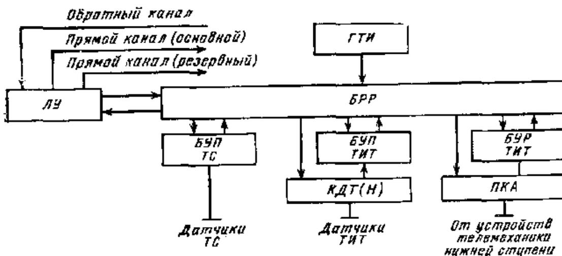
ПКА - преобразователь код-аналог; BUP (ТИТ)-блок управления режимом ТИТ; ЛУ-линейный узел; ГТИ - генератор тактовых импульсов; КДТ (Н)- коммутатор датчиков токов и напряжение.
