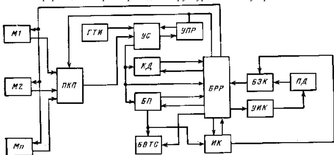
М1-М<sub>к</sub> - модемы; ГТИ - генератор тактовых импульсов; БВТС - блок воспроизведения ТС; ИК - интерфейсные карты; ПД - пульт диспетчера
