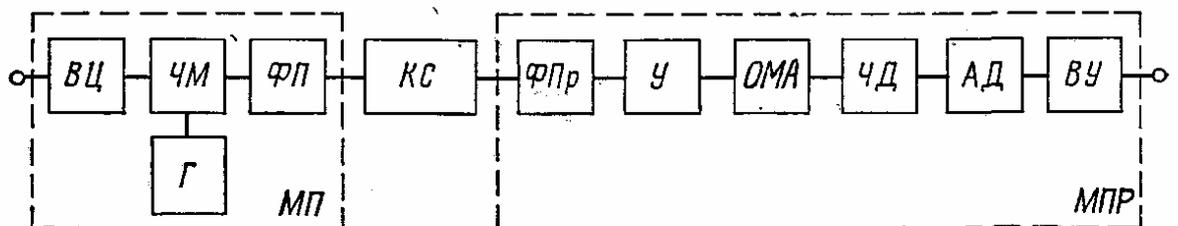
Модем передачи МП содержит узел входной цепи ВЦ частотный модулятор ЧМ, генератор тональной частоты Г и фильтр передачи ФП.
