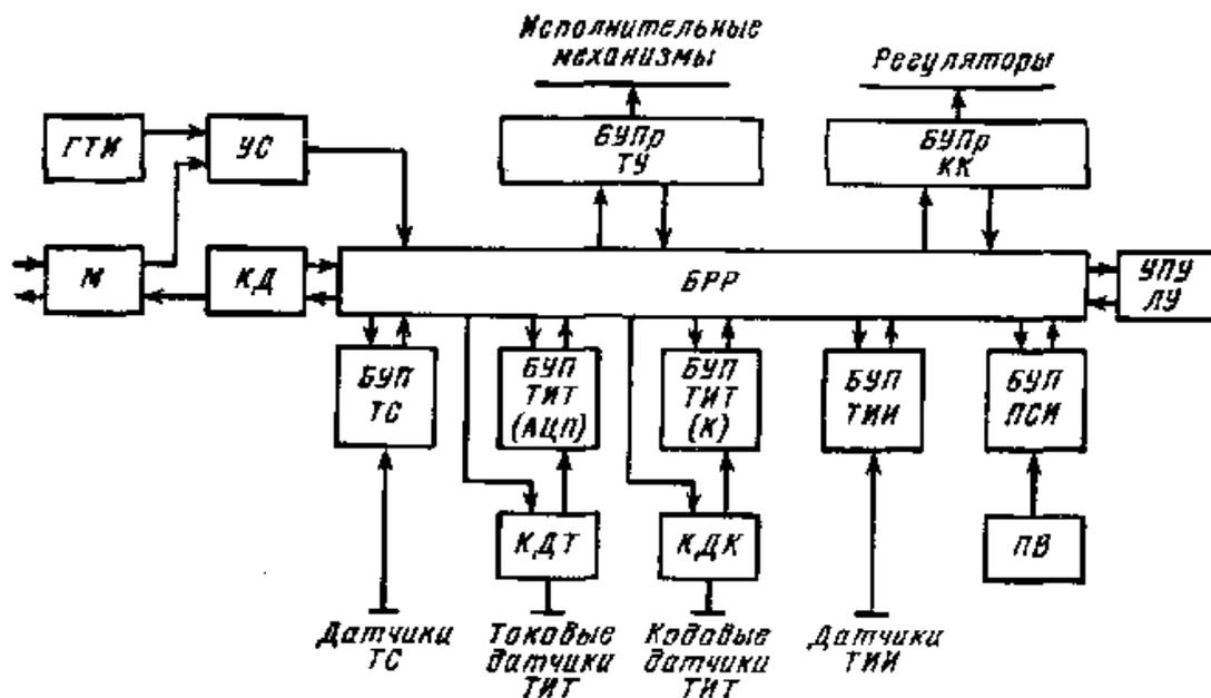
БУПр ТУ и БУПр КК- блоки управления приемом ТУ я кодовых команд; УПУ ЛУ - устройство ПУ линейного узла; БУП - блоки управления передачей; ТС - телесигнализации, ТИТ (АЦП) и ТИТ (К) - телеизмерений текущих значений от токовых и кодовых датчиков, ТИИ - телеизмерений интегральных значений; ПСИ - производственной статистической информации; ПВ - пульт ввода.
