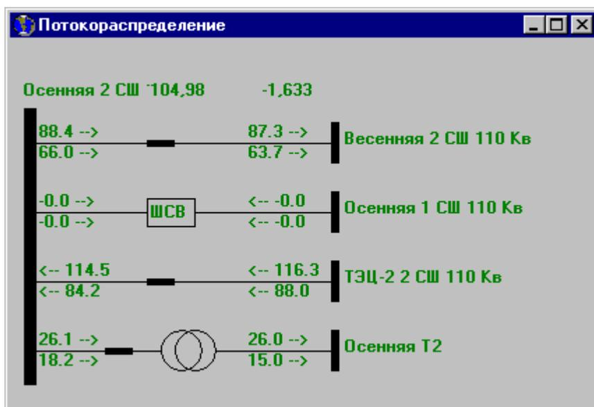
*Для линии* (рис. 7) выдается информация о напряжении, текущем и максимальном токах (при отсутствии ограничения по току, выдаются символы "\*\*\*\*\*"), состоянии линии (вкл., откл., блокировано изменение), коэффициенте перегруженности линии.
