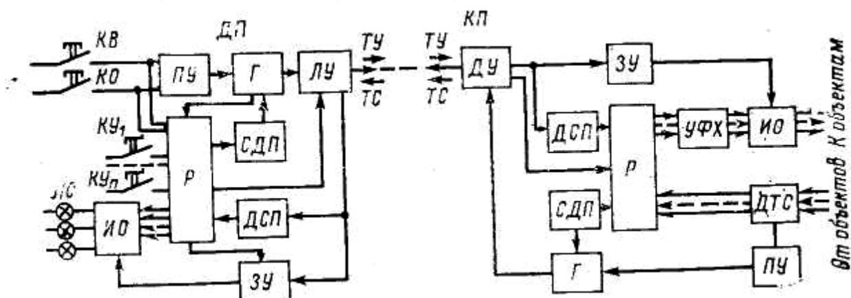
Рис. 8.6. Времязраспределительное контактное устройство ТУ —ТС
