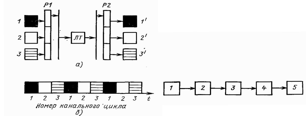
Цифровые системы передачи предусматривают передачу информации в ЛТ в виде импульсных последовательностей (цифр) при скорости передачи этих импульсов от 1,5 до 560 млн. имп./с. Для передачи импульсов на таких скоростях необходимы специальные кабельные линии связи. Такими линиями связи являются коаксиальные кабели связи обычных и специальных конструкций, световодные кабели или световоды.
