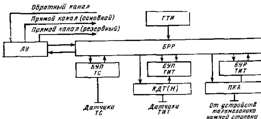
ПКА - преобразователь код-аналог; БУР (ТИТ)-блок управления режимом ТИТ; ЛУ-линейный узел; ГТИ - генератор тактовых импульсов; КДТ (Н)- коммутатор датчиков токов и напряжение.
