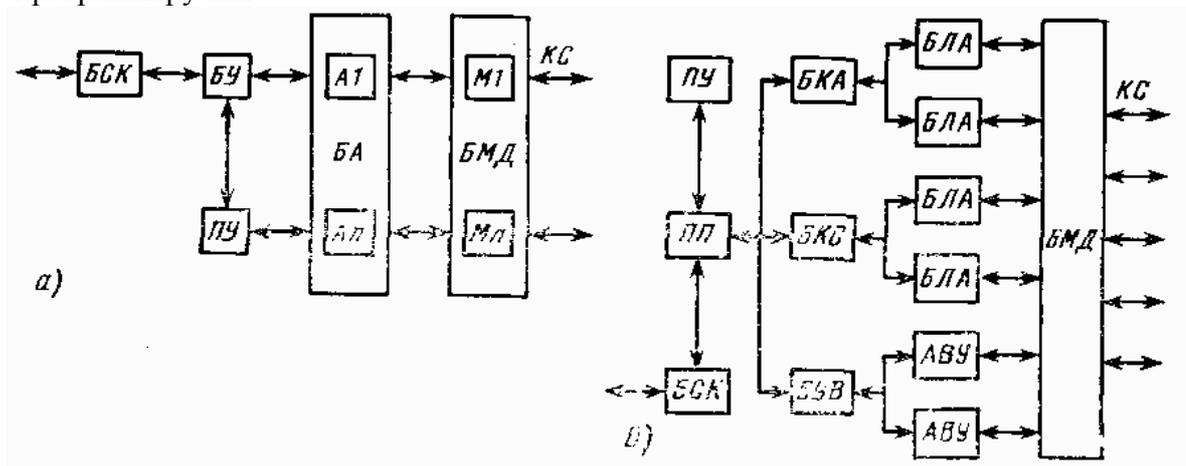
Рис. Функциональные схемы мультиплексора передачи данных:
