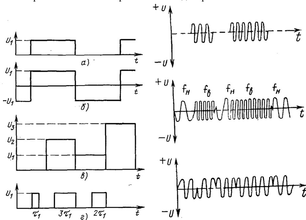
Информационным параметром сигнала постоянного тока является либо амплитуда напряжения (рис. а - в), либо длительность сигнала (рис. г). Как видно из рис. а, в однополярном двоичном сигнале амплитуда напряжения сигнала может принимать только два значения: 0 и  $U_1$ ; в двоичном двухполярном сигнале (рис. б)  $-U_1$  и  $+U_1$ .
