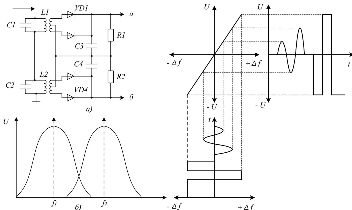
*a* - схема детектора; *б* - частотная характеристика детектора;
