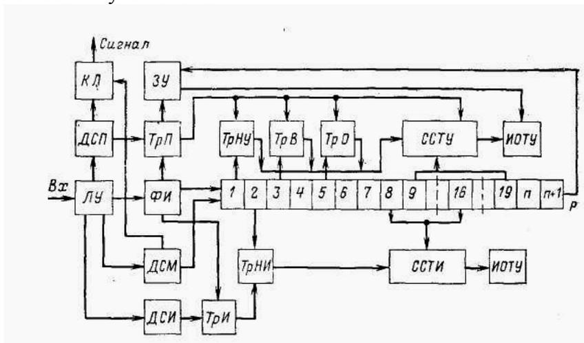
Рис. Структурная схема приемника ТУ устройства ВРТФ-1
