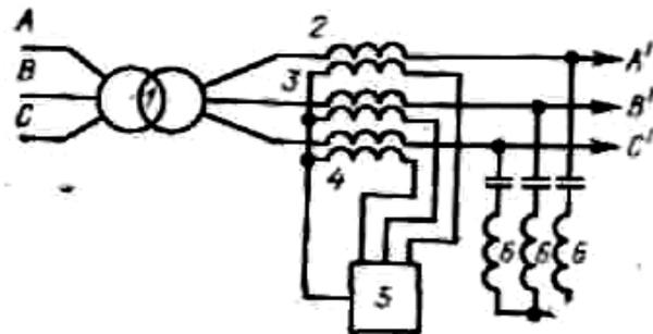
Рис. Схема подключения модема на КП по схеме «три фазы»
