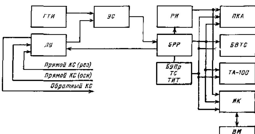
ТА-100 - специализированная ЭВМ; ИК- интерфейсные карты для связи с ЭВМ; ВМ - вычислительная машина; остальные обозначения приведены ранее.
