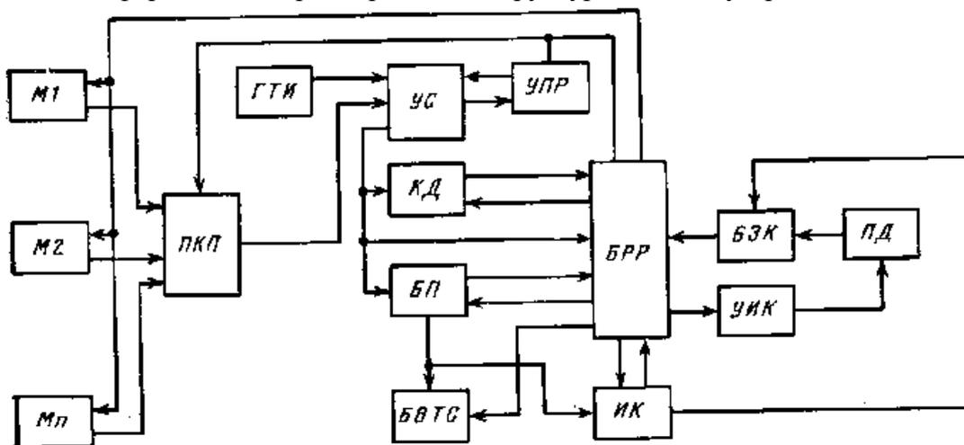
М1-Мк - модемы; ГТИ - генератор тактовых импульсов; БВТС - блок воспроизведения ТС; ИК - интерфейсные карты; ПД - пульт диспетчера
