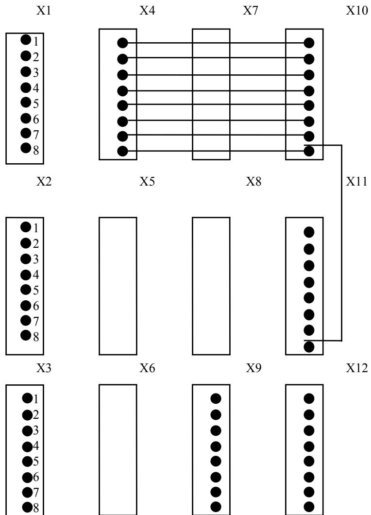
Схема соединений светового щита.
