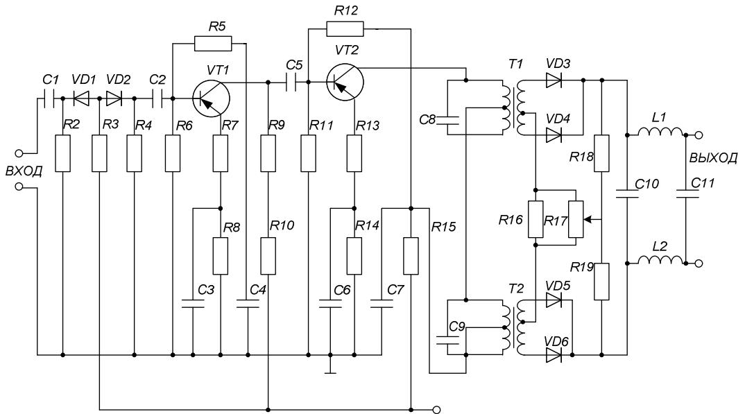
Рис. Принципиальная схема ограничителя максимальных амплитуд и частотного детектора
