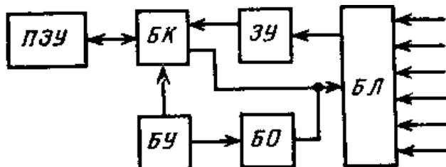
Рис. Функциональная схема узла коммутации сообщений
