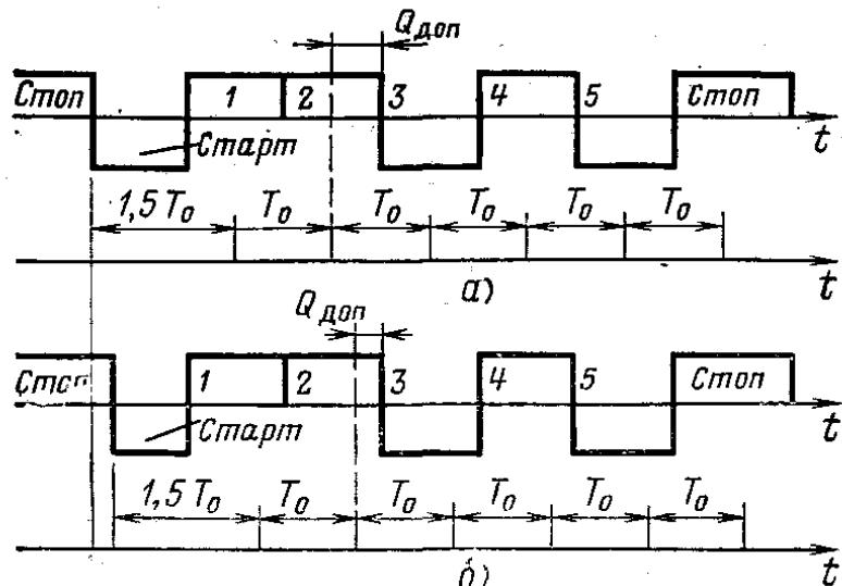
На рис. а приведены временная диаграмма неискаженных посылок старт-стопной комбинации и расположение укороченных контактов (моментов стробирования).
