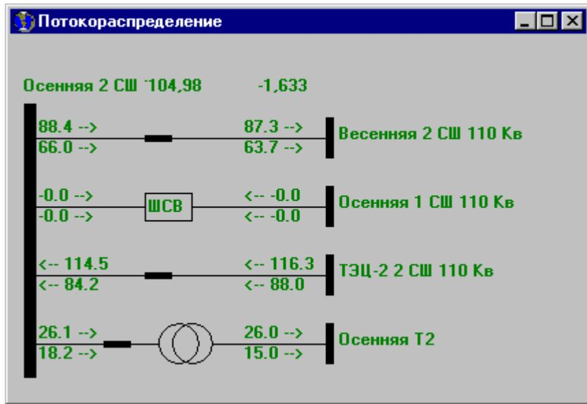
**Для линии** (рис. 7) выдается информация о напряжении, текущем и максимальном токах (при отсутствии ограничения по току, выдаются символы "\*\*\*\*"), состоянии линии (вкл., откл., блокировано изменение), коэффициенте перегруженности линии.
