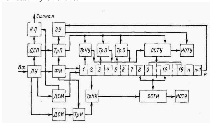
Рис. Структурная схема приемника ТУ устройства ВРТФ-1
