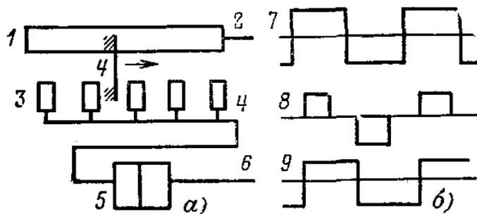
В моменты приема средней части каждой посылки осуществляется стробирование, которое в данном случае представляет собой соединение укороченного контакта щеткой 4 с кольцом 1. Время существования этой цепи (скольжения щетки по укороченному контакту) соответствует длительности стробирования а.
