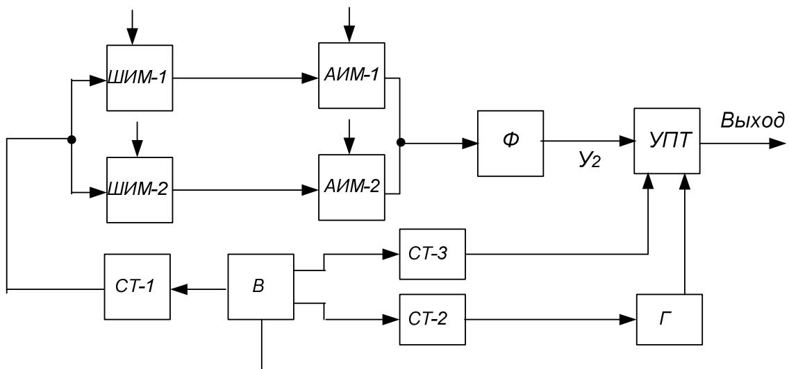
Схема содержит следующие узлы: блоки широтно-импульсной модуляции  $ШИМ$ , блоки амплитудно-импульсной модуляции  $АИМ$ , блок фильтров  $\Phi$ , усилитель постоянного тока  $УПТ$ , генератор  $\Gamma$ , выпрямитель  $B$ .
