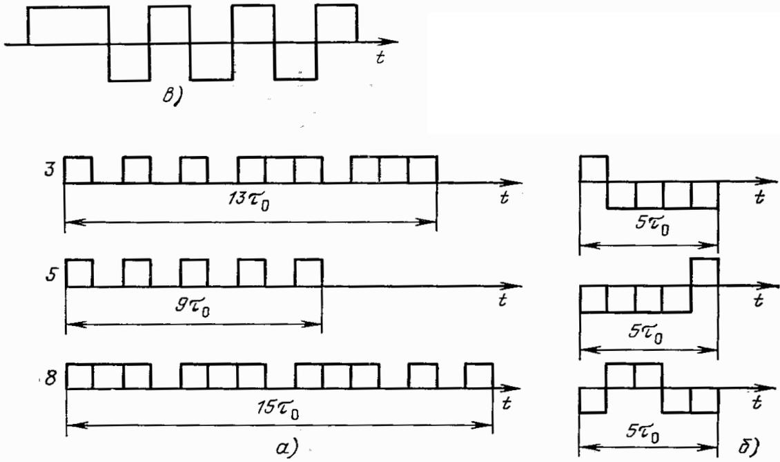
В общем случае при использовании кодовых сигналов не все возможные комбинации используются для передачи рабочей информации, часть комбинаций  $N_c$  используют в различных служебных целях, например для повышения достоверности передачи информации. Данное положение оценивается понятием коэффициента избыточности применяемого кода
