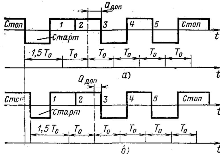
На рис. а приведены временная диаграмма неискаженных посылок страт-стопной комбинации и расположение укороченных контактов (моментов стробирования).
