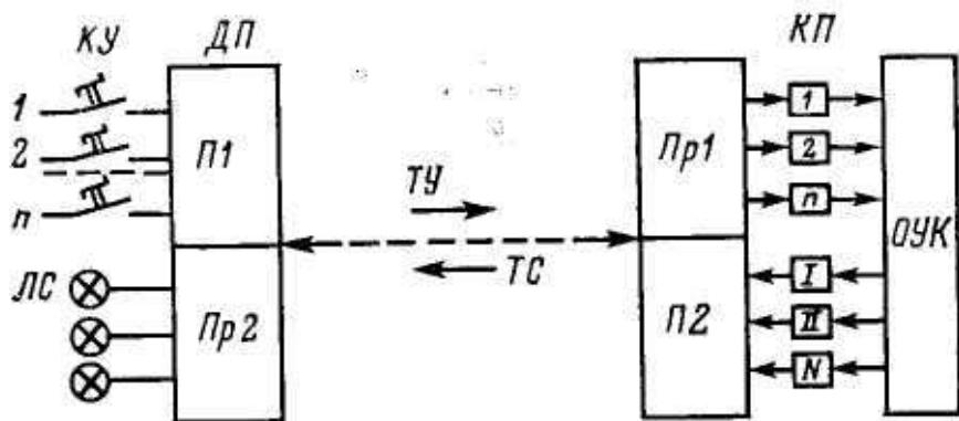
Рис. Структурная схема устройства ТУ — ТС:
