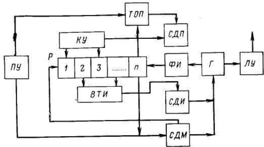
Рис. Структурная схема передатчика ТУ устройства ВРТФ-1
