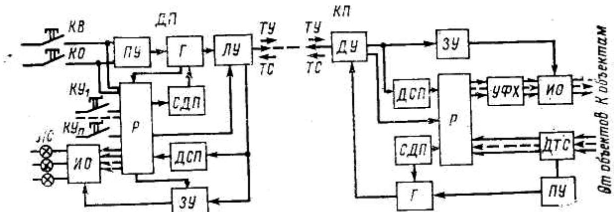
Рис. 8.6. Времяраспределительное контактное устройство ТУ — ТС
