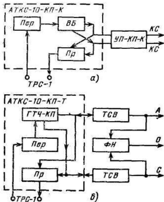
Рис. Функциональные схемы АТКС-10-КП
