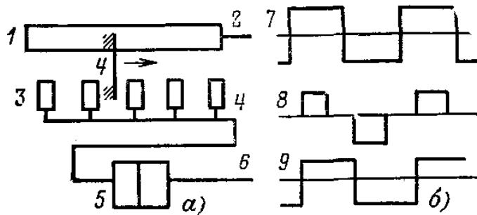
В моменты приема средней части каждой посылки осуществляется стробирование, которое в данном случае представляет собой соединение укороченного контакта щеткой 4 с кольцом 1. Время существования этой цепи (скольжения щетки по укороченному контакту) соответствует длительности стробирования  $a$ .
