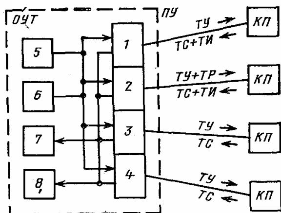
На рис. приведена функциональная схема многообъектной системы телемеханики, рассчитанной для работы по цепочечным и древовидным каналам связи.
