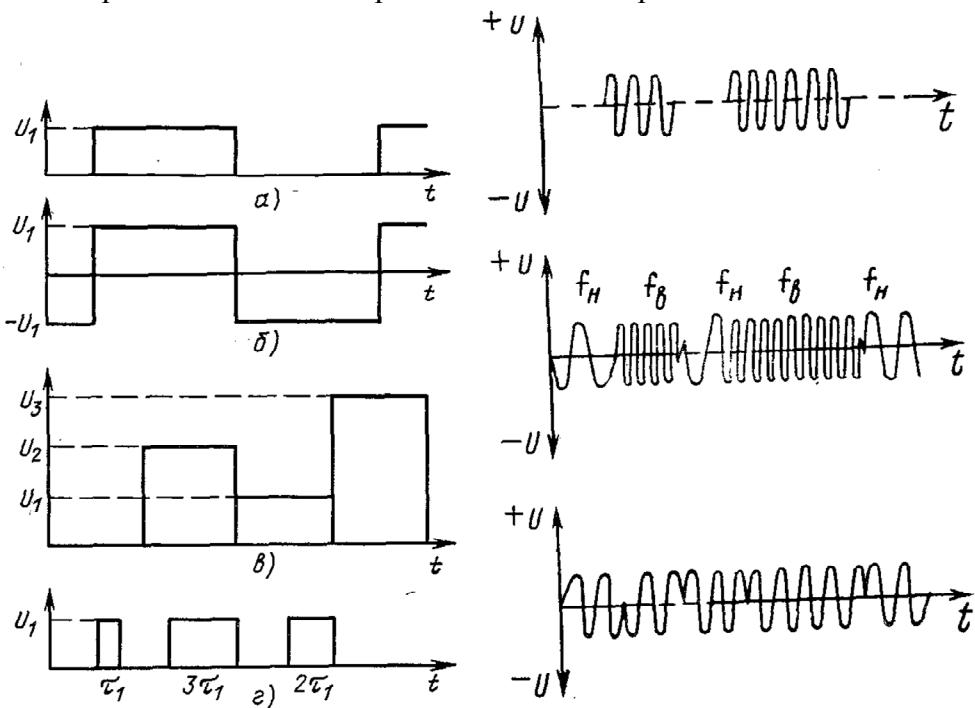
Информационным параметром сигнала постоянного тока является либо амплитуда напряжения (рис. а - в), либо длительность сигнала (рис. г). Как видно из рис. а, в однополярном двоичном сигнале амплитуда напряжения сигнала может принимать только два значения: 0 и  $U_1$ ; в двоичном двухполярном сигнале (рис. б)  $-U_1$  и  $+U_1$ .
