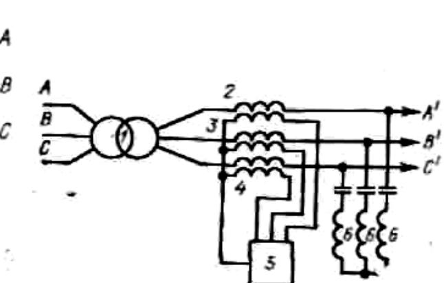
Рис. Схема подключения модема на КП по схеме «три фазы»
