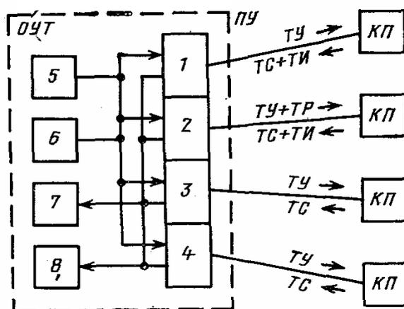
На рис. приведена функциональная схема многообъектной системы телемеханики, рассчитанной для работы по цепочечным а и древовидным б каналам связи.
