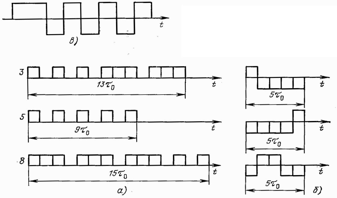
В общем случае при использовании кодовых сигналов не все возможные комбинации используются для передачи рабочей информации, часть комбинаций  $N_c$  используют в различных служебных целях, например для повышения достоверности передачи информации. Данное положение оценивается понятием коэффициента избыточности применяемого кода
