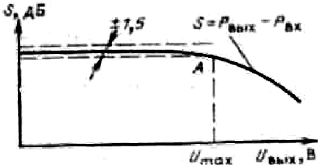
Для исключения взаимных влияний между каналами максимальная мощность передатчика должна быть распределена между сигналами отдельных каналов таким образом, чтобы сумма напряжений сигналов всех каналов не превышала  $U_{\text{max}}$ . При распределении мощности передатчика учитывают полосы рабочих частот отдельных каналов и их помехозащищенность.
