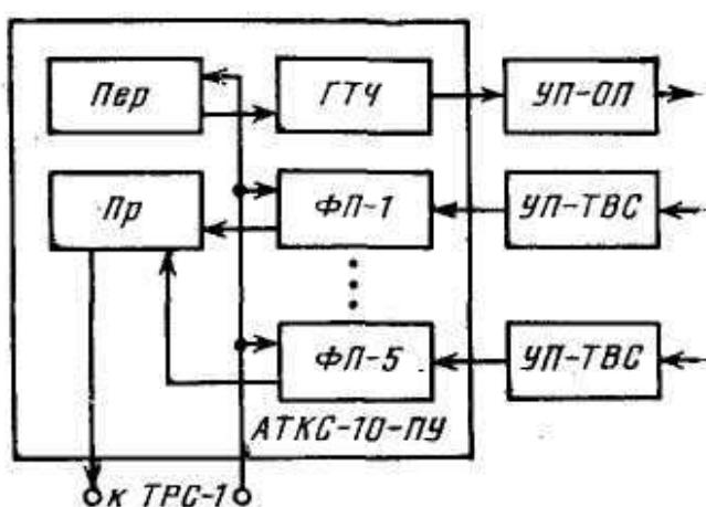
Рис. Функциональная схема АТКС-10 опорной подстанции ПУ
