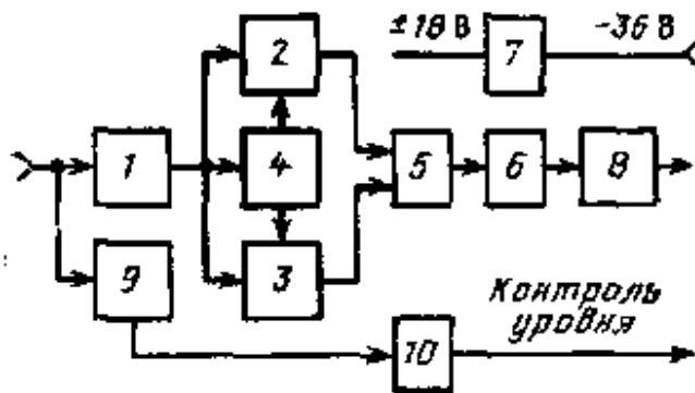
Рис. Функциональная схема линейного узла приема устройства МКТ-3
