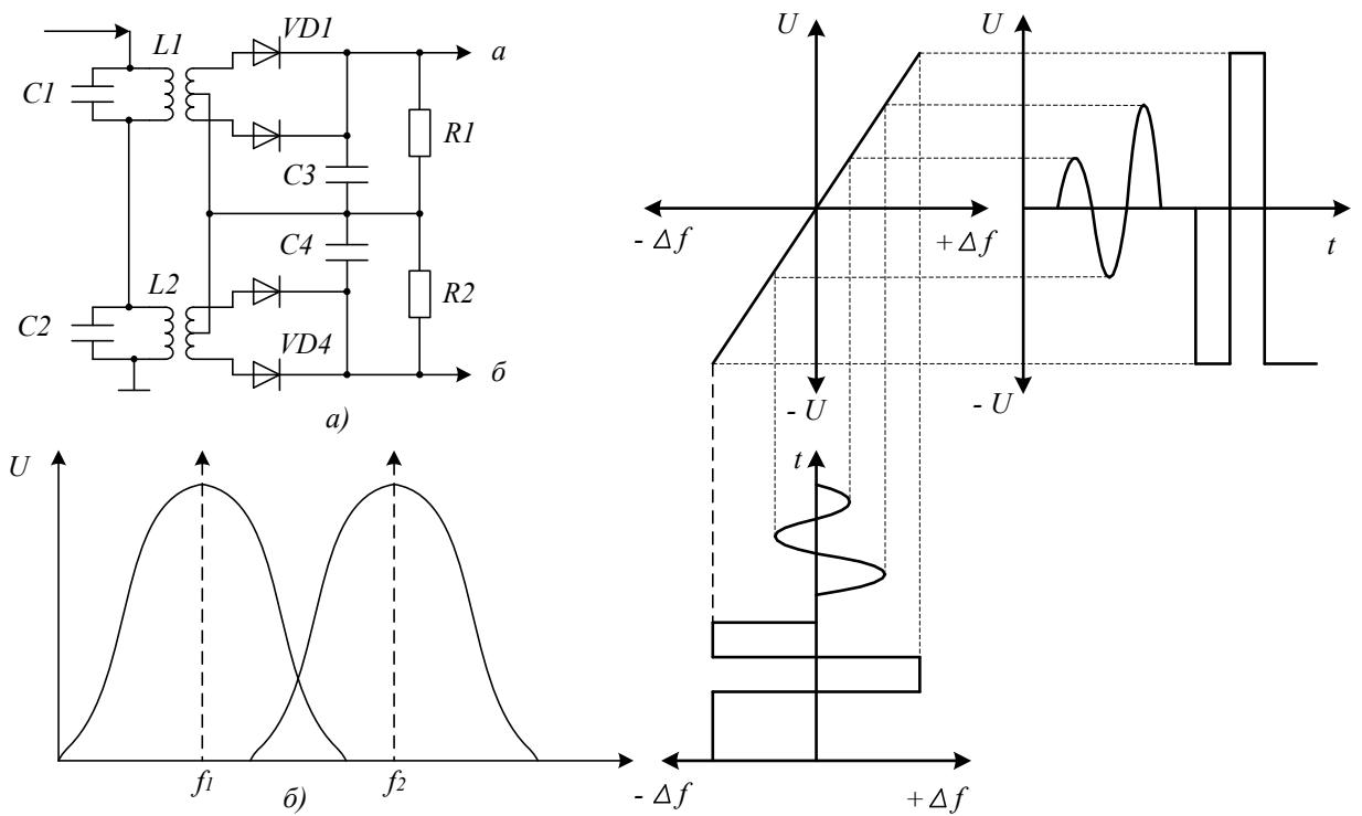
а - схема детектора; б - частотная характеристика детектора;
