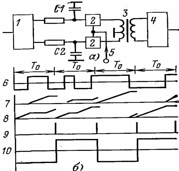
Узел приемного устройства состоит из распознавателя знака посылки 1, двух накопительных элементов - конденсаторов С1 и С2, двух логических элементов И (2), сумматора 3, выполненного в виде трансформатора, и выходного триггера 4. В заданные моменты времени из схемы приемного устройства на вторые входы элементов И подается кратковременный регистрирующий импульс с зажимом 5.
