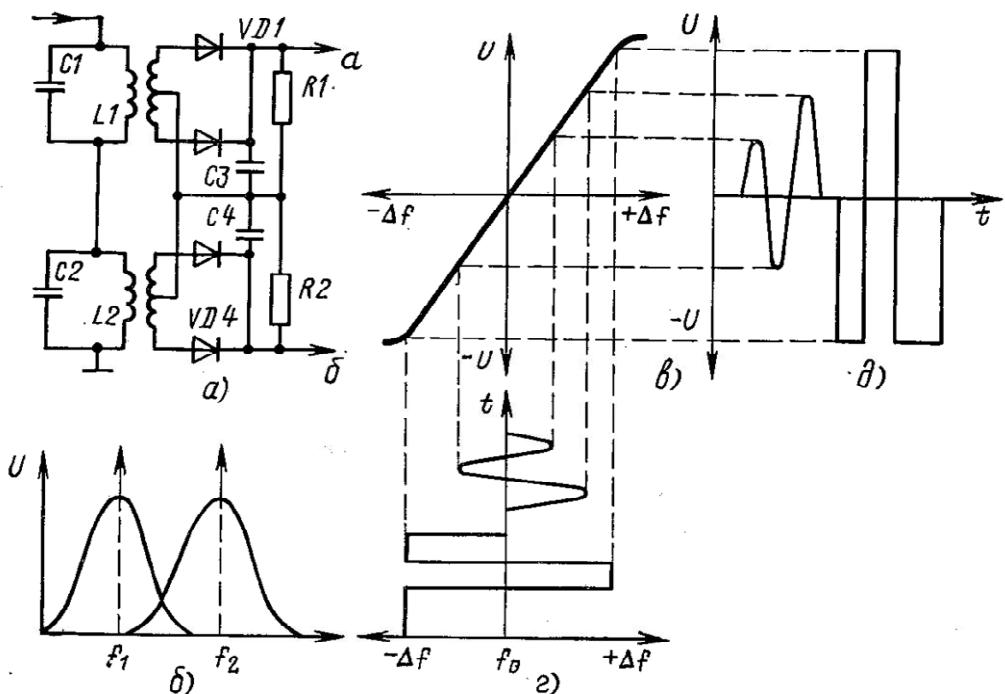
Преимуществами модемов с частотной модуляцией являются малая чувствительность к плавным изменениям остаточного затухания канала связи и повышенная помехозащищенность по сравнению с модемами АМ. На качество работы КТМ - ЧМ сказывается частотная погрешность в КС.
