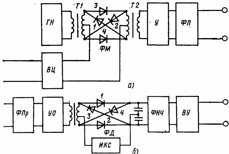
Прием фазомодулированных колебаний осуществляется с помощью фазовых детекторов ФД, которые превращают изменение фазы приемного сигнала в изменение полярности первичного сигнала на своем выходе. Для работы ФД необходимо иметь так называемое опорное напряжение несущей частоты, синхронное и синфазное напряжение немодулированного несущего колебания модема передачи.
