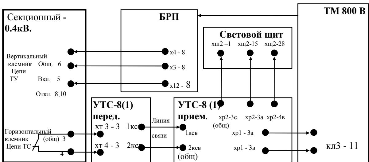
Схема соединений блока реле повторителей (БРП)
