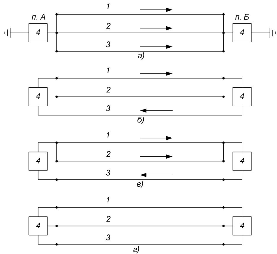
Рис. Упрощенные функциональные схемы подключения модемов телемеханики к ВЛ:
