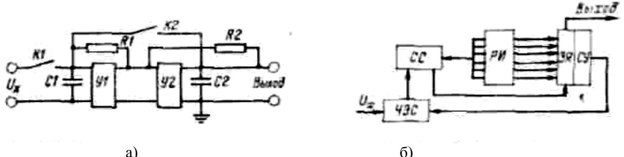
Таким образом, каждое из вводимых в алгебраическую сумму слагаемых последовательно удваивается: первое  $n$  раз, второе  $(n-1)$  раз и т. д. К концу кодирования первое введенное слагаемое  $2^n U$  возрастает в  $(n-1)$  раз, второе введенное слагаемое — в  $2^n$  раза и т. д.
