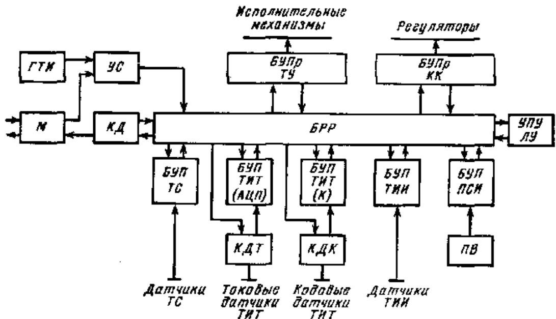
ВУПр ТУ и БУПр КК - блоки управления приемом ТУ я кодовых команд; УПУ ЛУ - устройство ПУ линейного узла; БУП - блоки управления передачей; ТС - телесигнализации, ТИТ (АЦП) и ТИТ (К) - телеизмерений текущих значений от токовых и кодовых датчиков, ТИИ - телеизмерений интегральных значений; ПСИ - производственной статистической информации; ПВ - пульт ввода.
