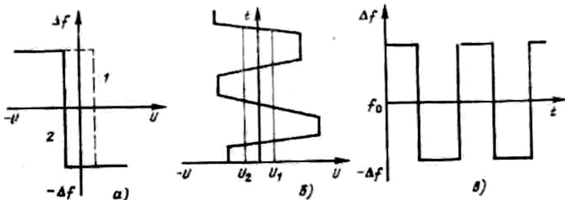
Рис. Модуляционная характеристика (а) и осциллограмма первичного сигнала на входе модема передачи (б) и форма ЧМ сигнала на входе модема (в)
