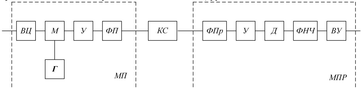
Первичный сигнал, поданный на вход модема передачи, проходит входную цепь ВЦ и поступает на модулятор М. На второй вход М подается сигнал тональной частоты от генератора несущей частоты Г.
