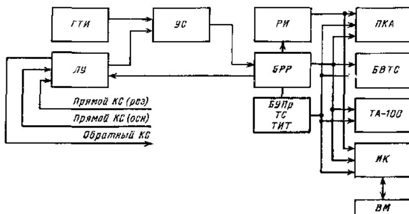
ТА-100 - специализированная ЭВМ; ИК- интерфейсные карты для связи с ЭВМ; VM - вычислительная машина; остальные обозначения приведены ранее.
