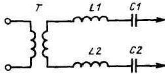
Рис. Схема устройства присоединения УП-КП-К.
