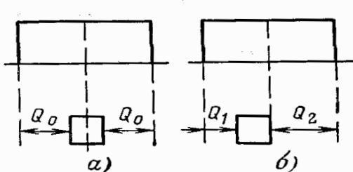
не окажут воздействия на качество посылок, поступающих с выхода триггера 5, т. е. искаженные в указанных пределах линейные посылки будут исправлены. Если момент стробирования будет смещен относительно середины посылки (рис. б), то допустимое значение искажений линейной посылки, которая будет исправлена приемным устройством, окажется меньше, чем в предыдущем случае, и определится формулой
