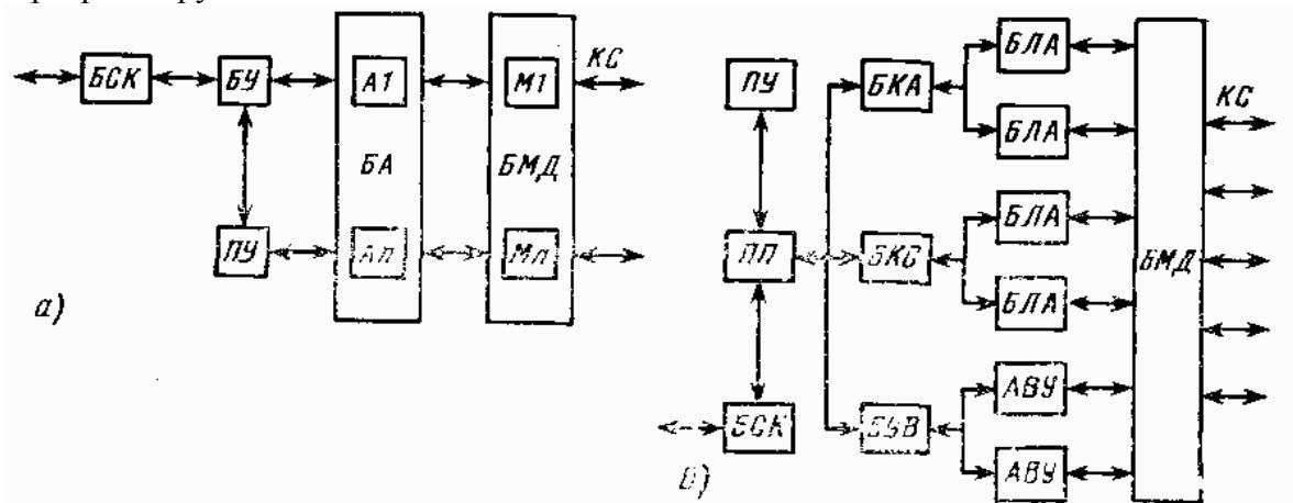
Рис. Функциональные схемы мультиплексора передачи данных:
