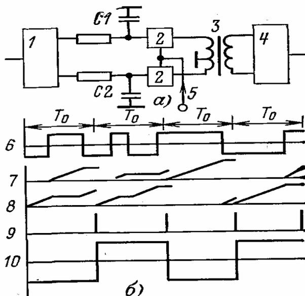
Узел приемного устройства состоит из распознавателя знака посылки 1, двух накопительных элементов - конденсаторов С1 и С2, двух логических элементов И (2), сумматора 3, выполненного в виде трансформатора, и выходного триггера 4. В заданные моменты времени из схемы приемного устройства на вторые входы элементов И подается кратковременный регистрирующий импульс с зажима 5.
