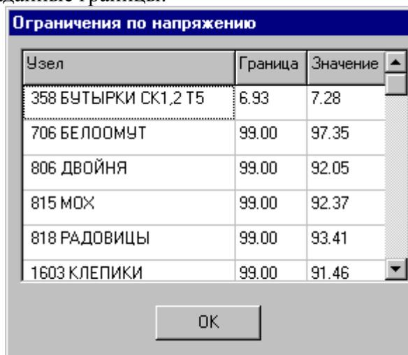
**Выход генерации реактивной мощности в генераторах схемы за заданные пределы.** При выборе в главном меню пункта "Ограничение  $Q_{\text{gen}}$ " открывается окно "Нарушение ограничения  $Q_{\text{gen}}$ ", содержащее имена узлов, в которых произошел выход генерации реактивной мощности за заданные границы.
