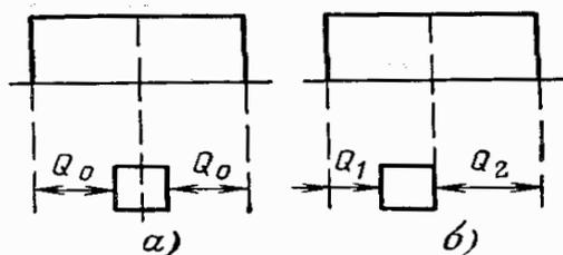
не окажут воздействия на качество посылок, поступающих с выхода триггера 5, т. е. искаженные в указанных пределах линейные посылки будут исправлены. Если момент стробирования будет смещен относительно середины посылки (рис. б), то допустимое значение искажений линейной посылки, которая будет исправлена приемным устройством, окажется меньше, чем в предыдущем случае, и определится формулой
