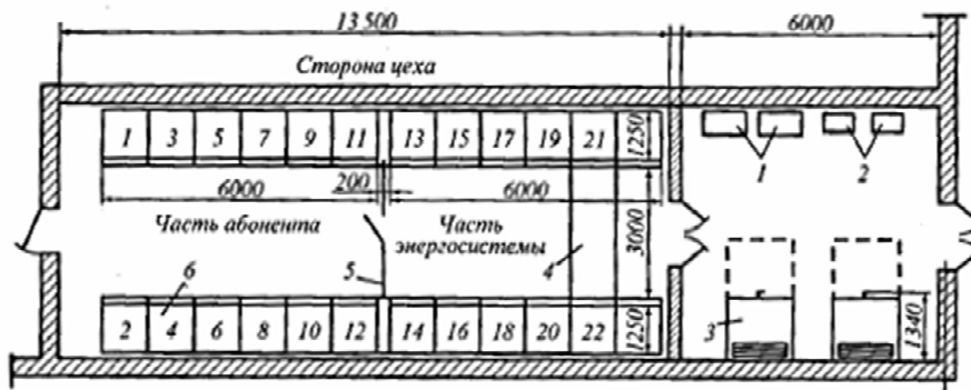
а) Расположение оборудования распределительной подстанции напряжением 10 кВ при двухрядном расположении камер КСО при разделении распределительной подстанции на части абонента и энергосистемы: 1 – блоки питания; 2 – щитки защиты; 3 – шкаф оперативного тока типа ШУОТ; 4 – мост шинный длиной 3000 мм; 5 – ограждение сетчатое с дверью; 6 – камера типа КСО-272
