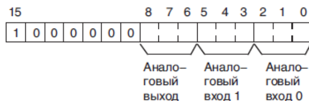
Рис. 3. Код диапазона модуля CP1W-MAD11.
