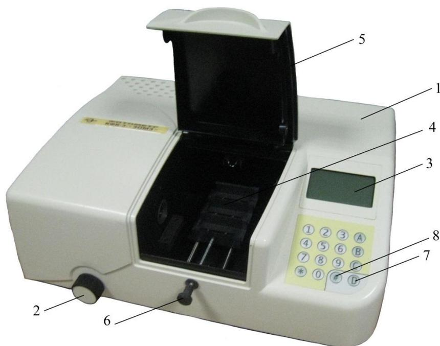
Рисунок 3 – Внешний вид фотоэлектроколориметра ЗОМЗ КФК-3-01.
