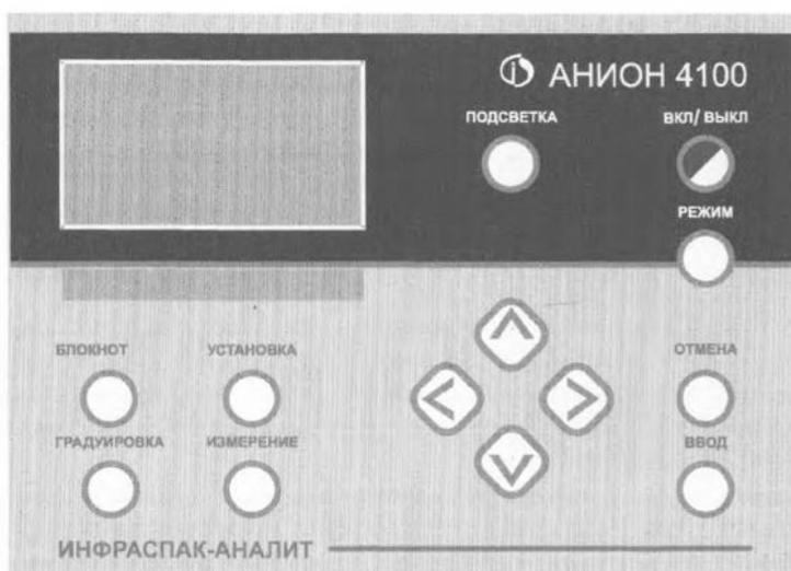
Рисунок 2 – Панель управления рН-метра / кондуктометра «АНИОН 4100»
