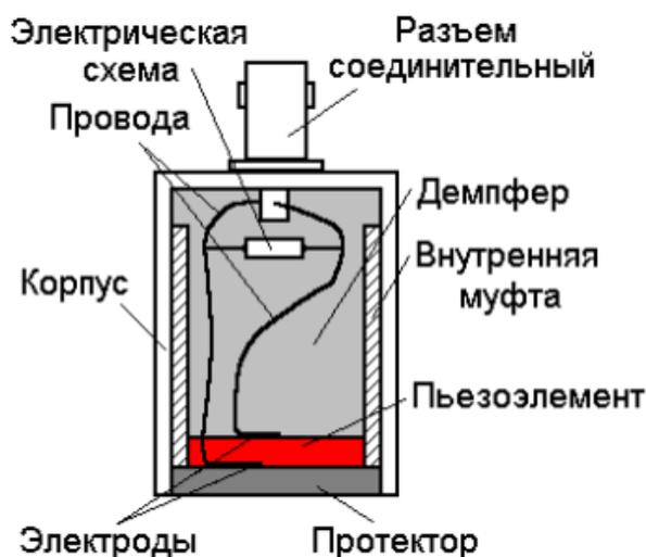
Рис. 5 Ультразвуковой пьезоэлектрический преобразователь (ПЭП)
