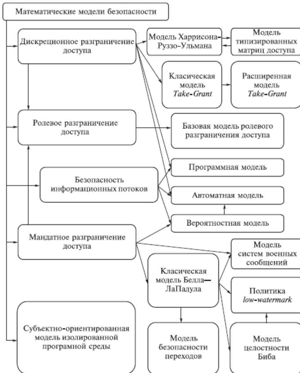
Рисунок 1 – Классификация и взаимосвязи положений математических моделей безопасности компьютерных систем
