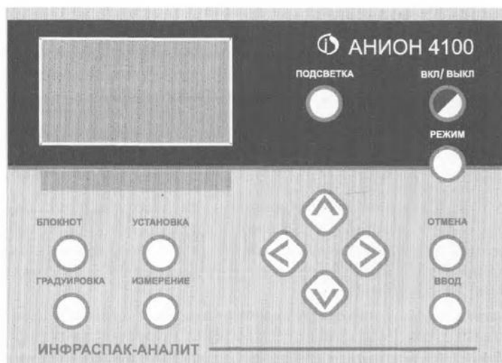
Рисунок 1 – Панель управления рН-метра / кондуктометра «АНИОН 4100»
