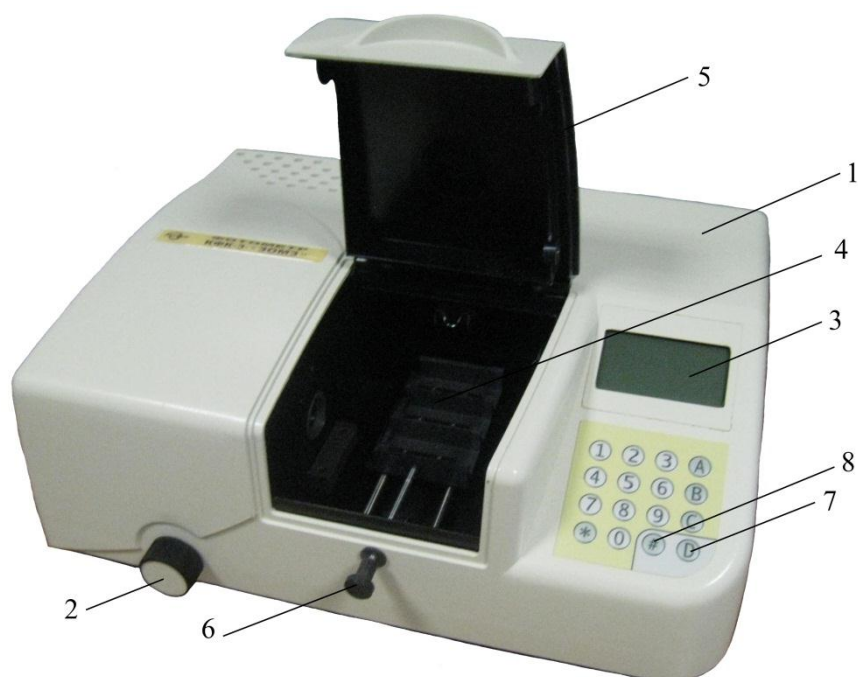
Рисунок 2 – Внешний вид фотоэлектроколориметра ЗОМЗ КФК-3-01.
