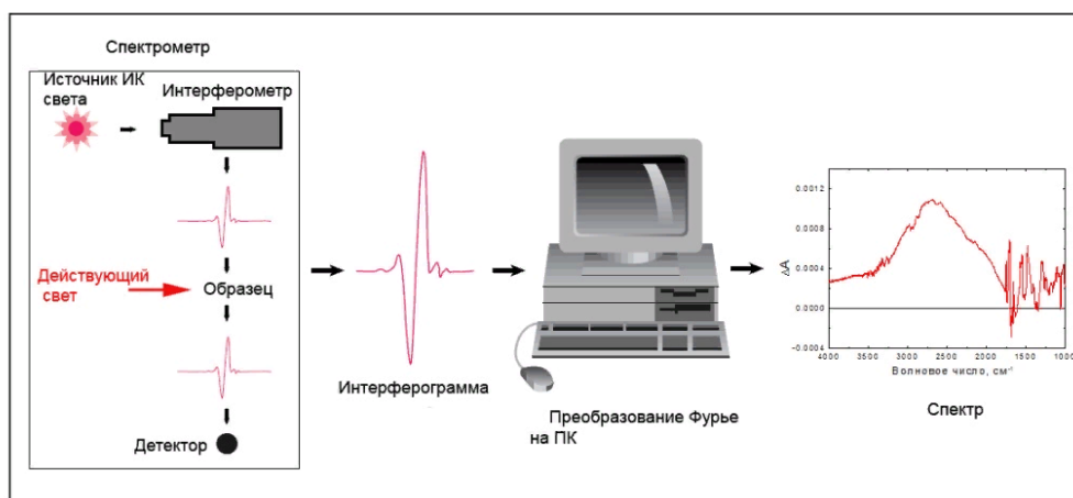
Рисунок 6 – Интерферометр (схема) с интерферограммой, ПК с преобразователем Фурье и картинкой ИК-спектра
